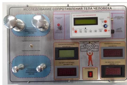
Рисунок 1 –Лабораторная установка для исследования тела человека
