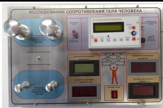
Рисунок 1 – Общий вид лабораторной установки для исследования тела человека
